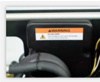
Denne mærkat advarer dig om de residuelle farer inde i WAZER Pump Box's elektriske kabinet og instruerer om, at den ikke må åbnes.
