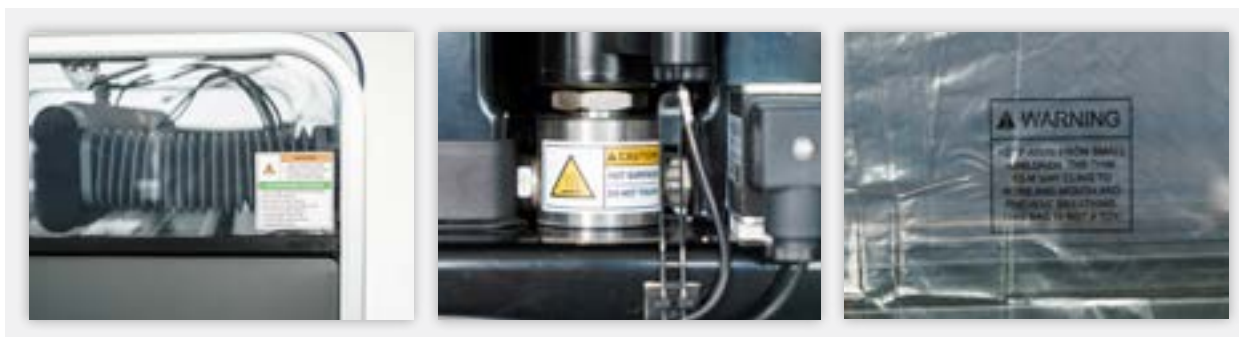
Denne mærkat advarer dig om faren for elektrisk stød forbundet med en forkert slangefrakoblingsprocedure. Den tjener også til at instruere dig om den korrekte afbrydelsesprocedure.
