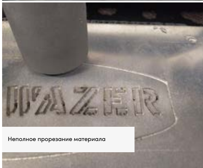
Признак неполного прорезания материала
