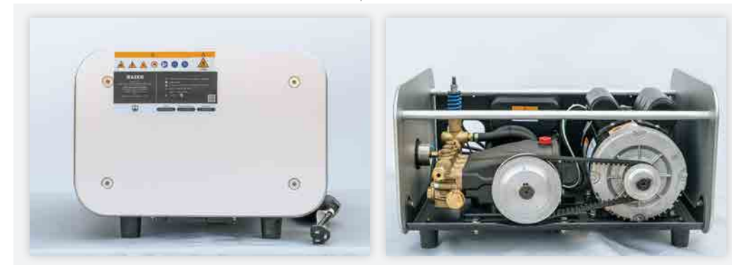
Nach dem Auspacken finden Sie die WAZER-Haupteinheit in einem Zustand wie diesem vor. Beachten Sie alle Warnetiketten, da sie wichtige Sicherheitshinweise für alle Personen enthalten, die dieses Gerät bedienen, warten und reparieren.
