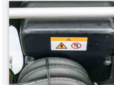
Dit label waarschuwt u voor de resterende gevaren in de WAZER Pump Box Electrical Enclosure en instrueert dat deze niet mag worden geopend.
