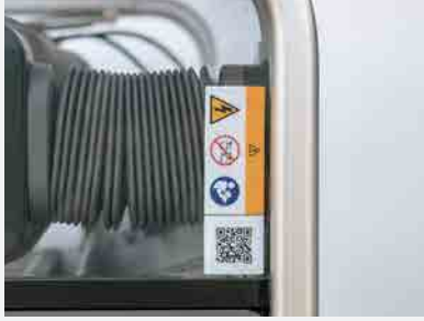
Dit label waarschuwt u voor het gevaar van elektrische schokken dat gepaard gaat met een onjuiste procedure voor het loskoppelen van de slang. Het dient ook om u te instrueren over de juiste ontkoppelingsprocedure.
