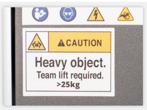
תויות זאת מזהירה אתכם בנוגע למשקל הכבד של ה-Pump Box (תיבת משאבה) של WAZER ומורה לכם להשתמש בטכניקות הרמה מתאימות בעת ההובלה.
