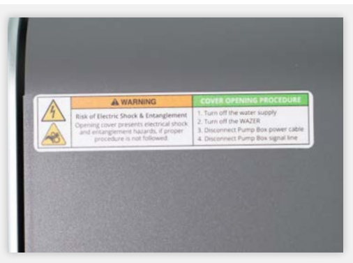
תויות זאת מזהירה אתכם בנוגע לסכנות הקשורות אל הפתיחה הלא נאותה של ה-Pump Unit (יחידת משאבה) של WAZER. היא גם משמשת למתן הוראות בנוגע לתהליך פתיחה נאות.
