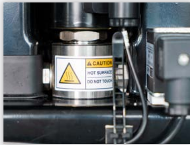
תויות זו מזהירה אתכם מסכנת טמפרטורה גבוהה בקרבת המכונה.
